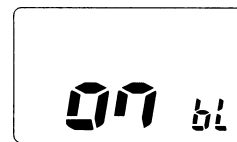
Automatisk fönstersbelysning PÅ (standard-läge).
