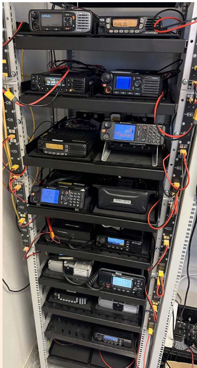
Labbutrustning med några av de radio som stöds a Mimer Soft-radio.
